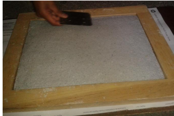
Figura 66. Moldeado de panel
