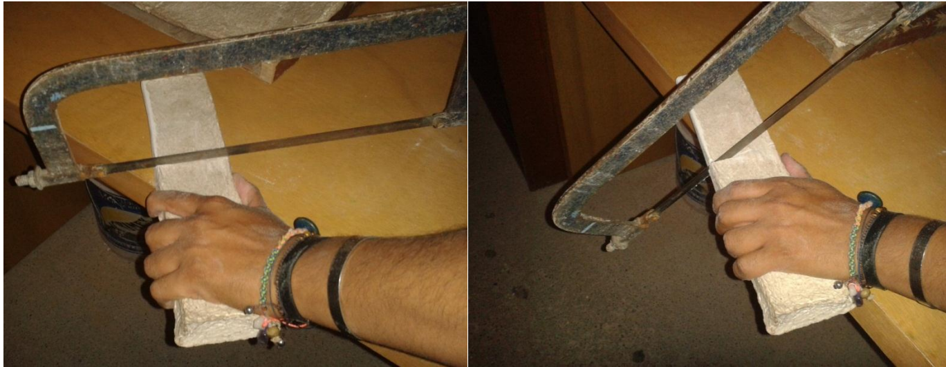
Figura 44. Corte realizado al panel empleando una segueta
