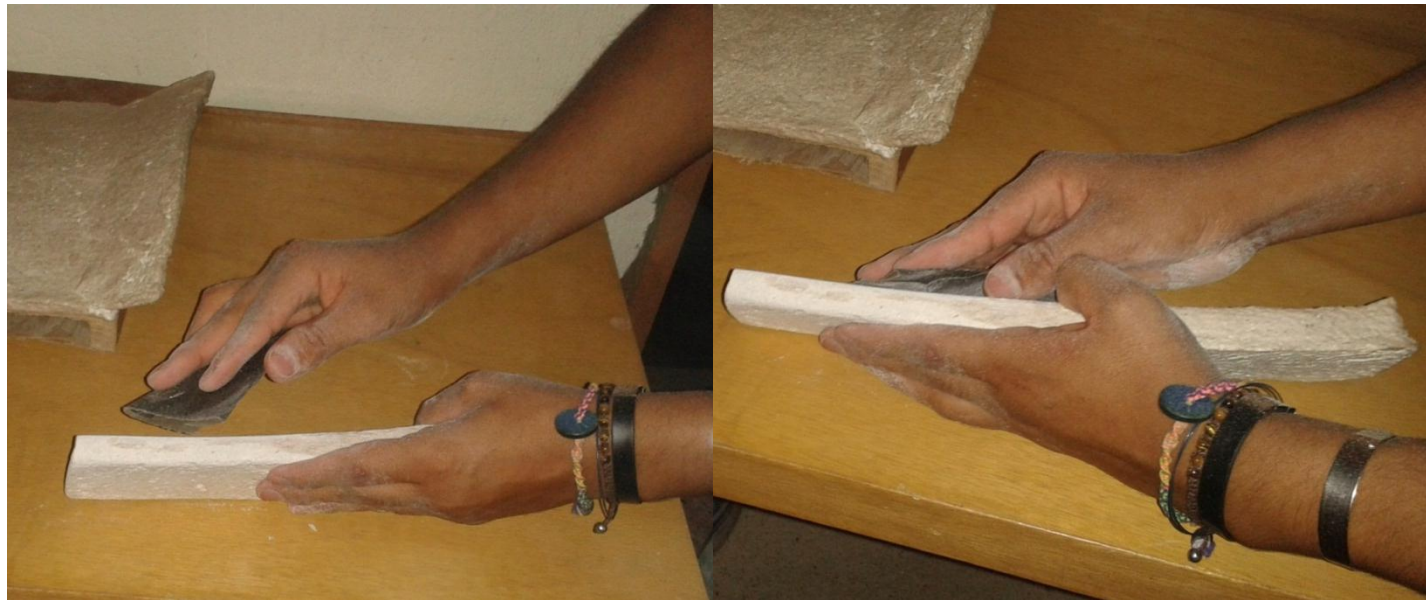
Figura 43. Pulido del panel obtenido con la tercer probeta
