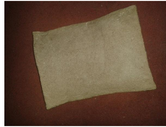
Figura 30. Panel deformado por la falta de presión
