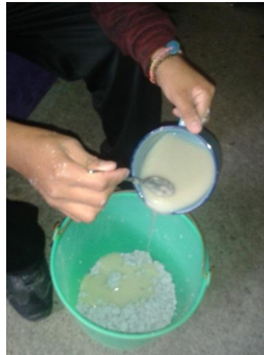
Figura 49. Mezcla entre el aglutinante y la pasta de papel
