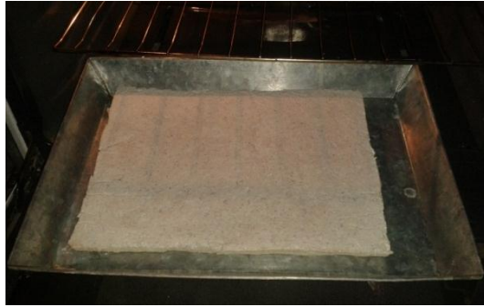
Figura 72. Panel sometido a cocción.
