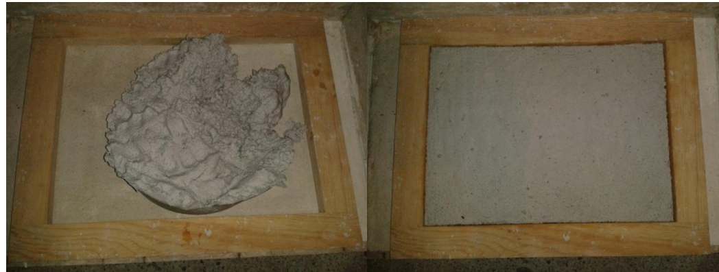
Figura 55. Moldeado del panel a las medidas propuesta 30 x 40 cm grosor de 2 cm
