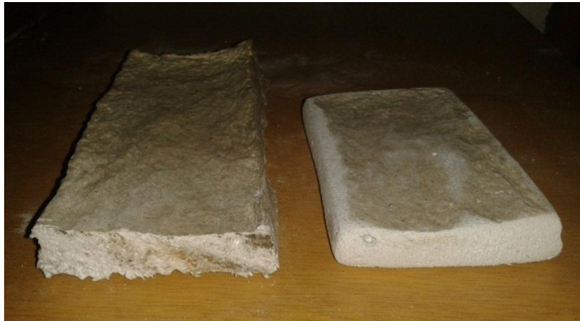
Figura 45-46 La parte que se cortó del panel en la probeta 3, se sometió a pulido y considerablemente se aprecia el cambio que sufrió.
