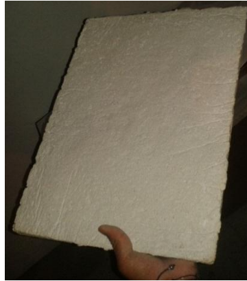
Figura 69. Vista de la porosidad que presenta el panel.
