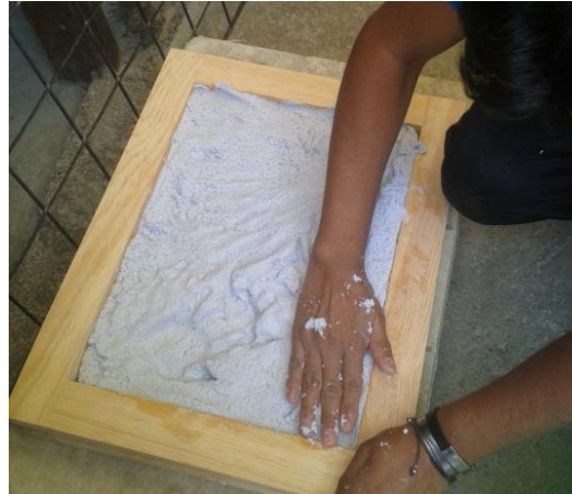
Figura 26. Moldeado del panel
