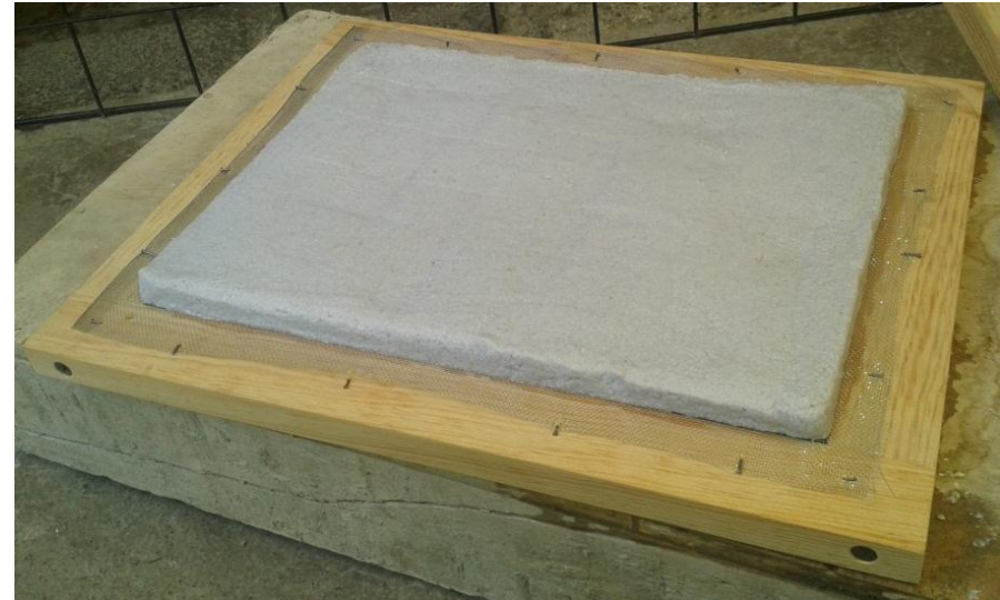
Figura 28. Panel en proceso de secado Fuente: Propia, 2014
