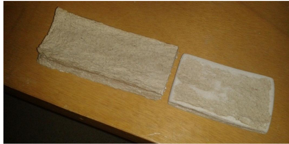
Figura 45-46 La parte que se cortó del panel en la probeta 3, se sometió a pulido y considerablemente se aprecia el cambio que sufrió.
